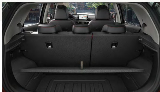
Dwupoziomowa podłoga bagażnika Podłogę bagażnika można podnieść do poziomu złożonego oparcia tylnej kanapy lub opuścić, by zmieścić wyższy bagaż.
