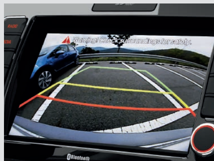
Nawigacja z kamerą cofania 7-calowy ekran intuicyjnego w obsłudze systemu nawigacji może również prezentować widok z kamery tylnej. Dzięki niej widać, ile miejsca pozostało za samochodem podczas cofania.
